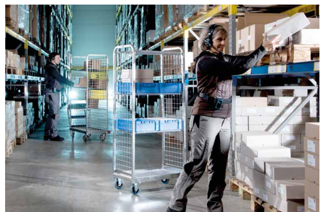
Kommissionierung mittels Pick-by-Voice
