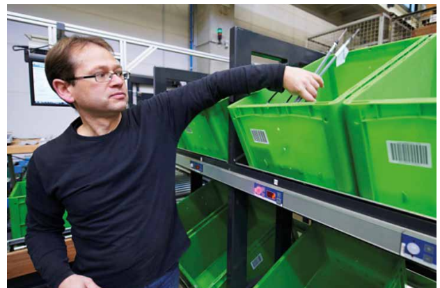
Kommissionierung mittels Pick-by-Light
